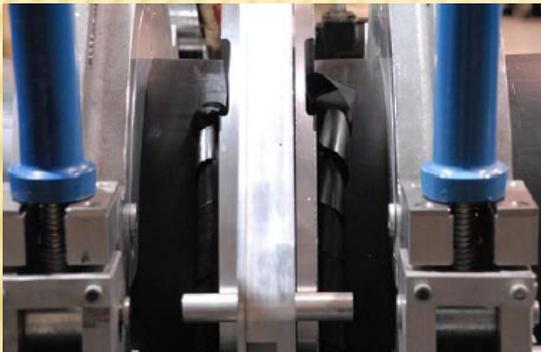
2- Faceamento das pontas para preparação para soldagem com o faceador
