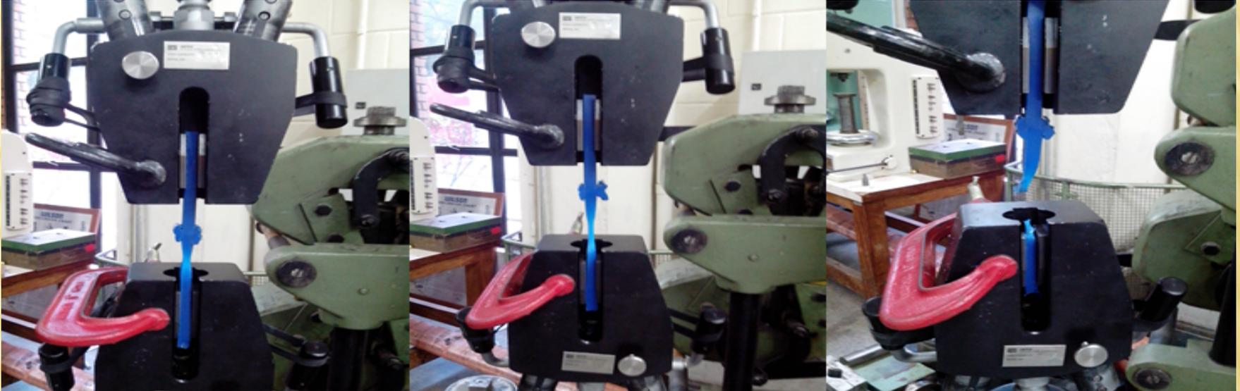
Foram feitos ensaios de tração em equipamento adaptado para esta finalidade que apresentou em todos os ensaios, a estrição fora da região de solda evidenciando que a região soldada por termofusão com a termofusora proposta apresenta maior resistência a ruptura em relação a região sem solda sem intervenções na região conectada.
