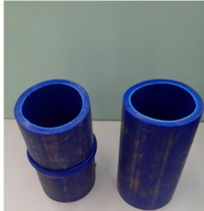
Dois elementos de tubos em PEAD, SDR 11, PE100, PN16, azul, foram soldados em termofusão através do protótipo do equipamento proposto. Após soldados os elementos apresentaram um só conjunto o qual foi cortado em filetes, apresentando larguras de 25mm; 22,4mm e 22,4mm
