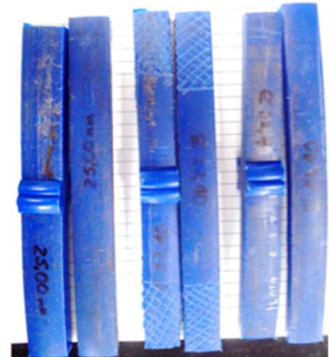
Para realização de métodos comparativos, foi cortado em filetes o mesmo tubo, em trecho sem a presença de solda, com mesmo comprimento em seções com mesmas larguras ao tubo soldado para realização do método comparativo.
