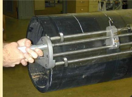
**5 - Raspar a área marcada, para eliminar a camada oxidada dos tubos retirando as rebarbas internas e externas (cantos vivos) das faces dos tubos;**
