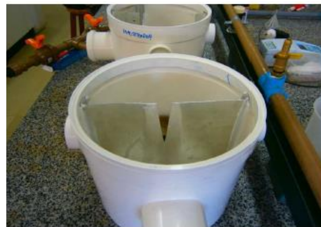
Medidor de vazão tipo vertedor triangular de parede delgada
