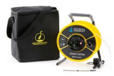
• Fita de 6,3 mm e o sensor fino permitem medições em poços estreitos
