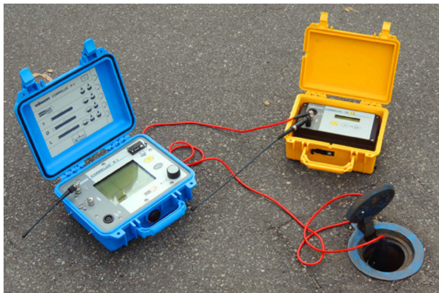
Figura 6: Técnicas acústicas para localização de vazamentos. a) Correlacionador. b) Geofone eletrônico.
