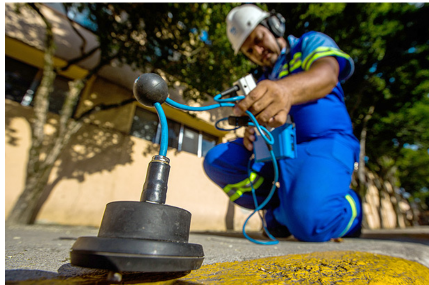
Figura 6: Técnicas acústicas para localização de vazamentos. a) Correlacionador. b) Geofone eletrônico.
