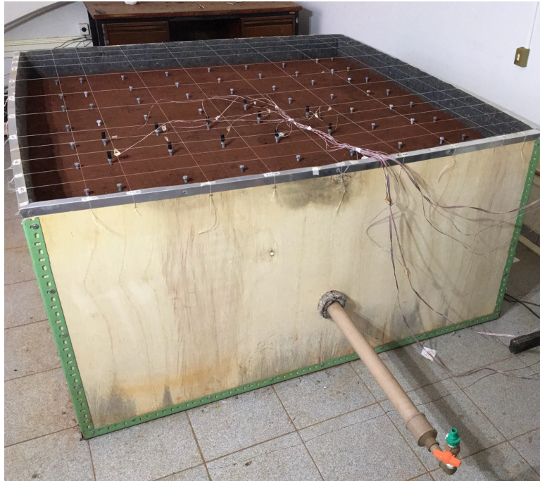
Figura 2: Ensaio experimentais. a) Estudo do comportamento dinâmico de diferentes geomateriais. b) Análise vibro-acústica em tubulações com vazamento de água
