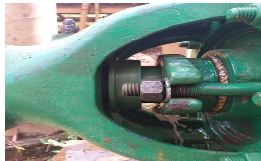
Gaxeta 2212 após 3 meses sem falhas e um ajuste apenas
