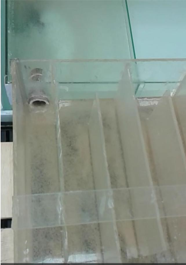
**Figura 15– Decantador – divisão pré decantador e decantador com retenção de flóculos**
