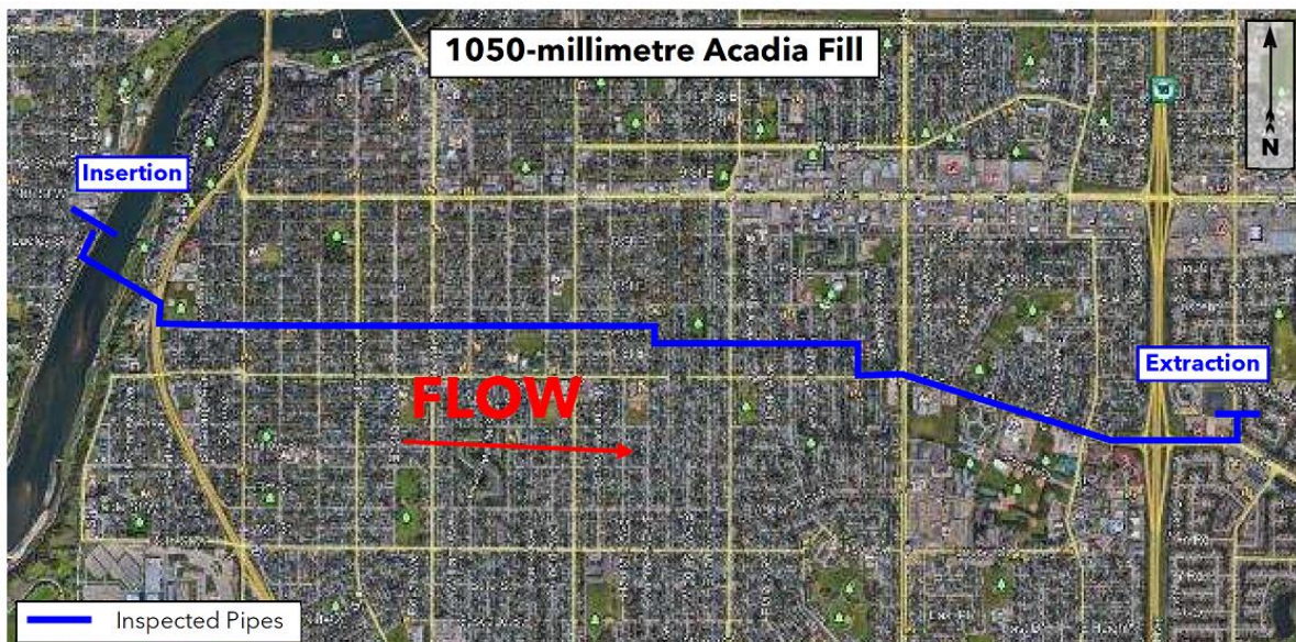
Figura 5. Extensão do Alinhamento e da Inspeção da Rede Principal Acadia Fill
