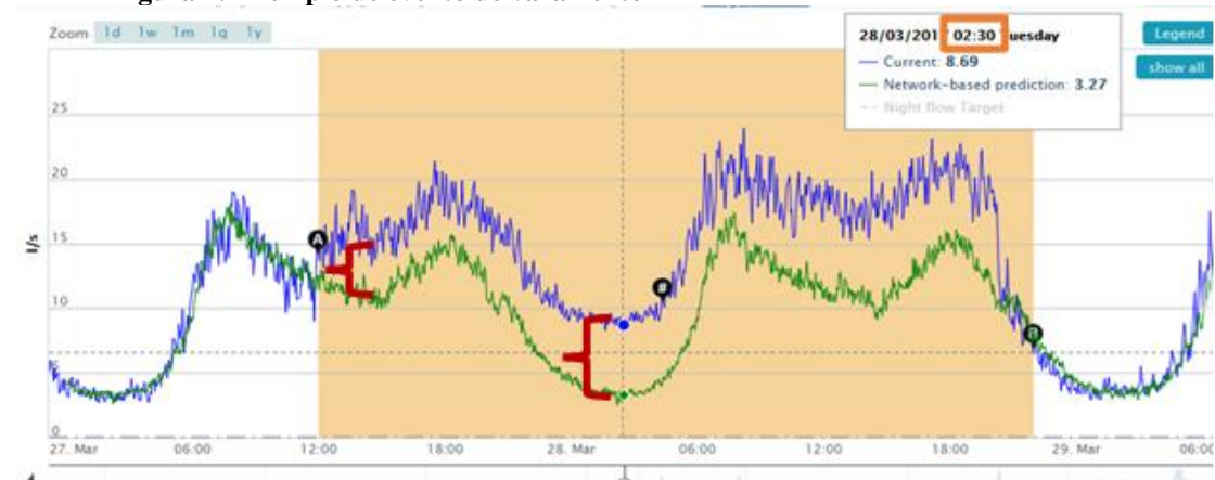
Figura 4: Exemplo de evento de vazamento
