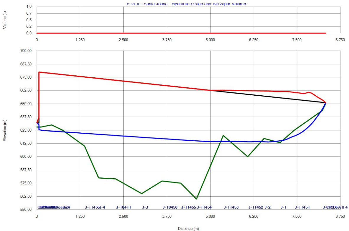
Figura 18 – Caso 3 – Resultados da Simulação da AAT, em FoFo e com Volante de Inércia
