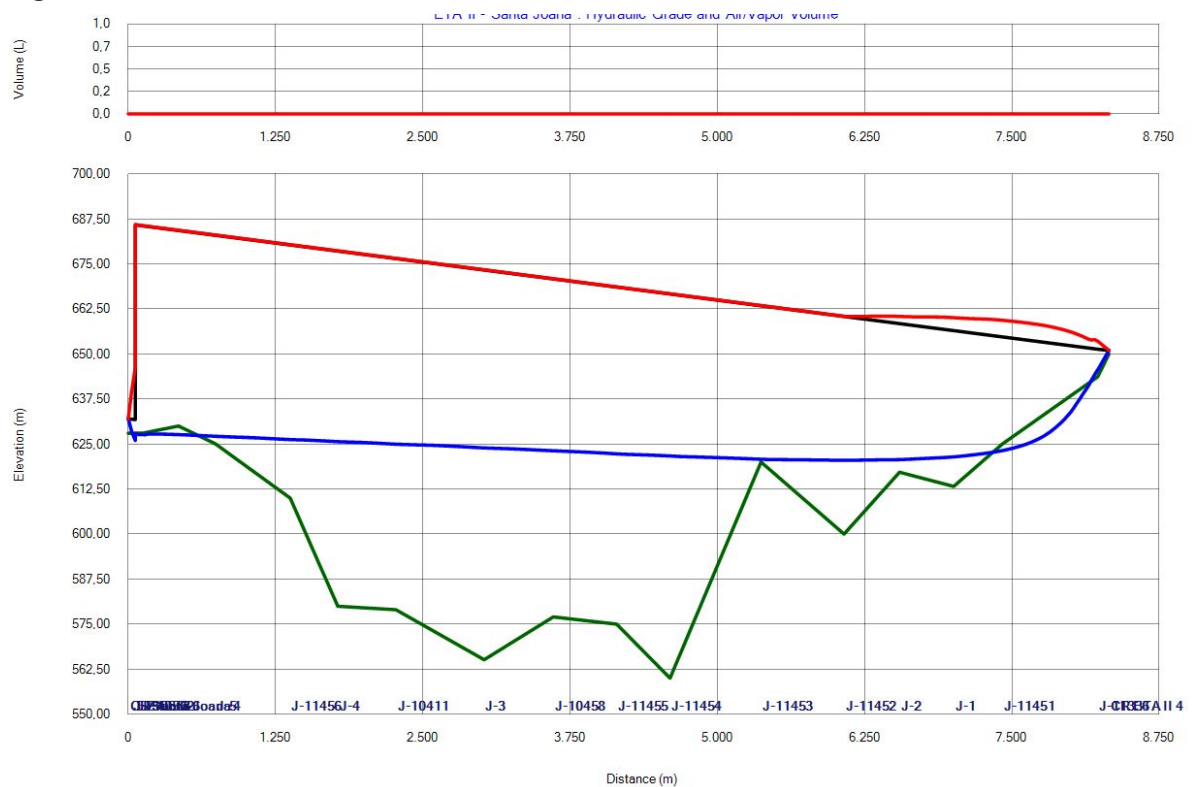
Figura 17 – Caso 3 – Resultados da Simulação da AAT, em PEAD e com Volante de Inércia
