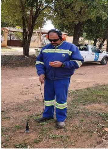
Figura 8 – Operador com geofone
