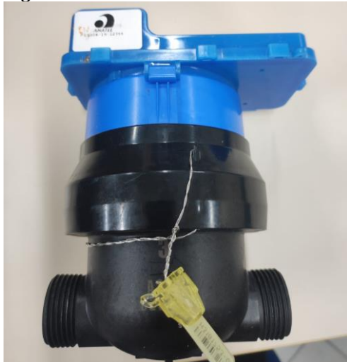
Figura 4 - Medidor volumétrico com transmissor instalado
