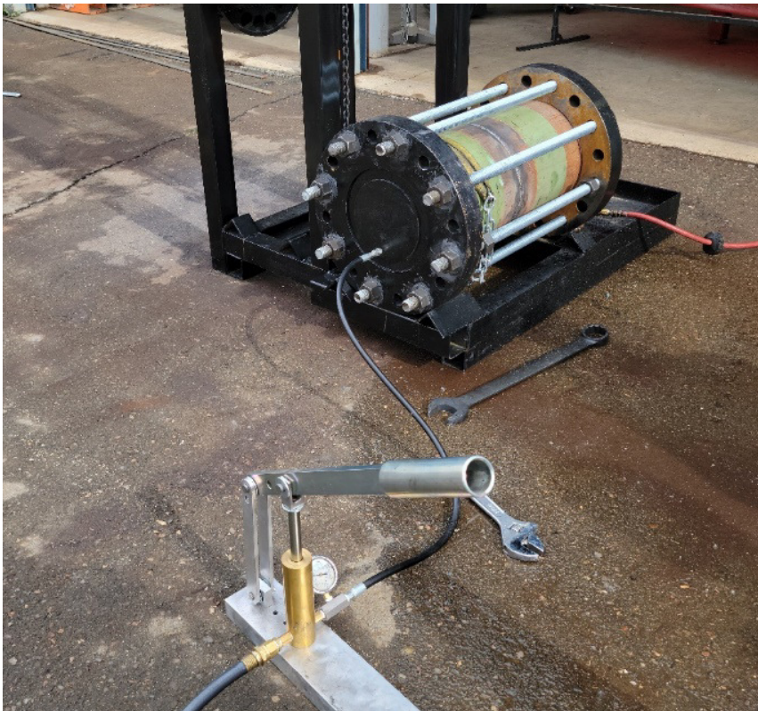
Figura 6 - Teste hidrostático em tubos DN 300 Schedule 40 montados com uma luva interna de proteção e selagem de juntas soldadas. Conjunto testado a 38 bar por 30 minutos.
