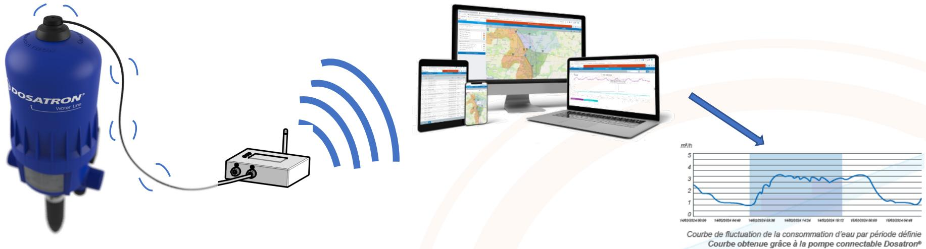
Com a nova tecnologia **CLACK N' TRACK**, sistema de contagem de vazão e transmissão de dados, é possível monitorar remotamente o status operacional da bomba e os níveis de potabilidade (em ppm), permitindo o planejamento otimizado das intervenções em campo e das atividades de manutenção.
