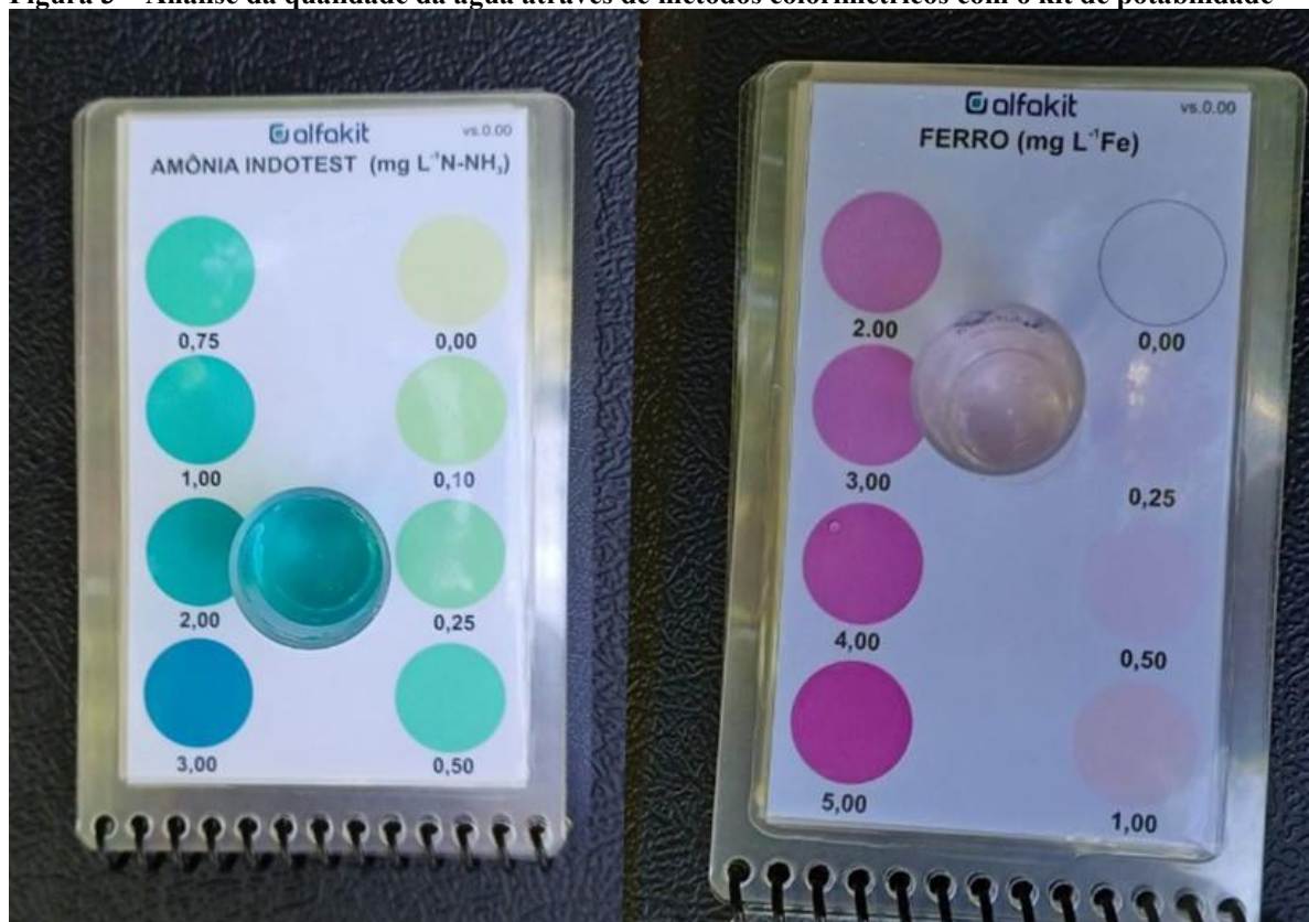
Figura 3 – Análise da qualidade da água através de métodos colorimétricos com o kit de potabilidade
